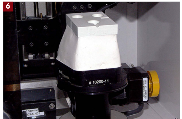
Positionnement de la plaque inférieure dans le Dental Wings avec l'interface de scannage.
